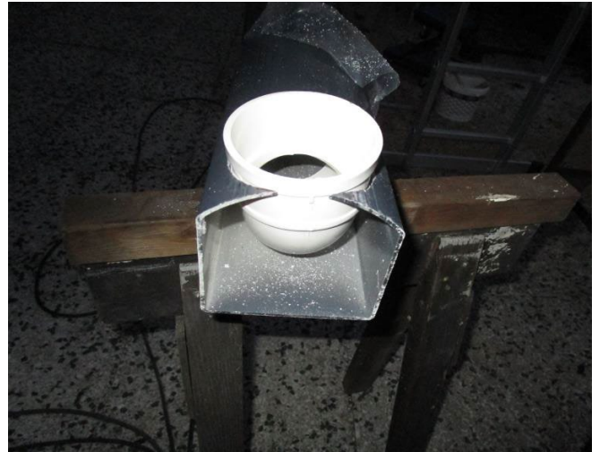
Schritt 8.1b - Den Ablauf unten einsetzen
