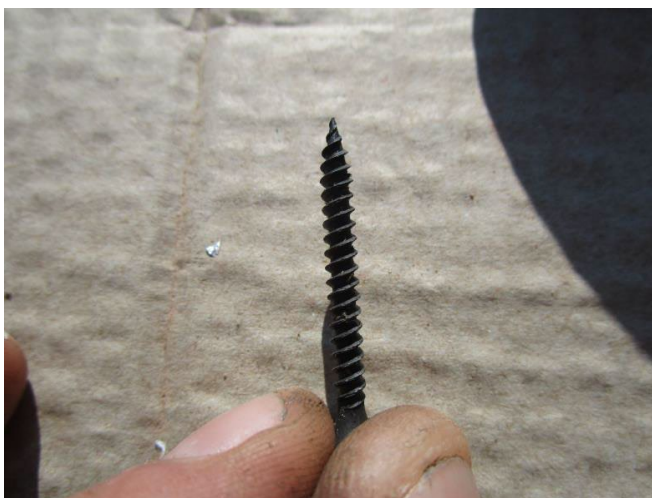
Schritt 16. - Unten Mittels Metallschraube befestigen (Metallschraube mit Gewinde für Metall) nicht im Lieferumfang enthalten
