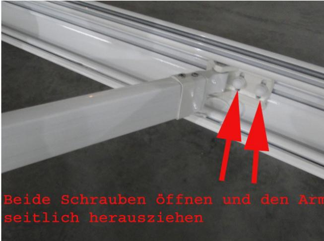
Jetzt die Befestigung im hinteren Bereich an der Markise selbst öffnen:
