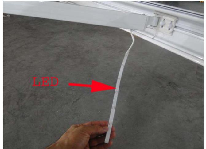
Jetzt müssen Sie die Stromversorgung: Plus und Minus Pol an dem neuen LED Streifen befestigen:
