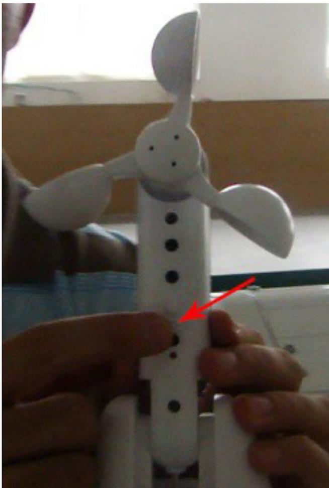
Achtung! Falls die Drehrichtung durch den Windwächter falsch eingestellt wurde, kann sich die Markise unkontrolliert öffnen. Testen Sie die richtige Drehrichtung daher in dem Sie bei geschlossener Markise den „Up“-Knopf betätigen. Falls sich die Markise öffnen sollte, müssen Sie unbedingt die Drehrichtung durch die folgenden Schritte ändern:
