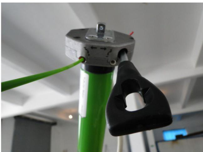
Um den Einstellpunkt zu erreichen, ohne das Gehäuse öffnen zu müssen, können Sie den Einstellstab durch das Kabelloch stecken, wie auf der folgenden Abbildung illustriert. Lassen Sie die Markise nun ca. 40cm Schließen und drehen Sie währenddessen die rote Einstellschraube nach links!
