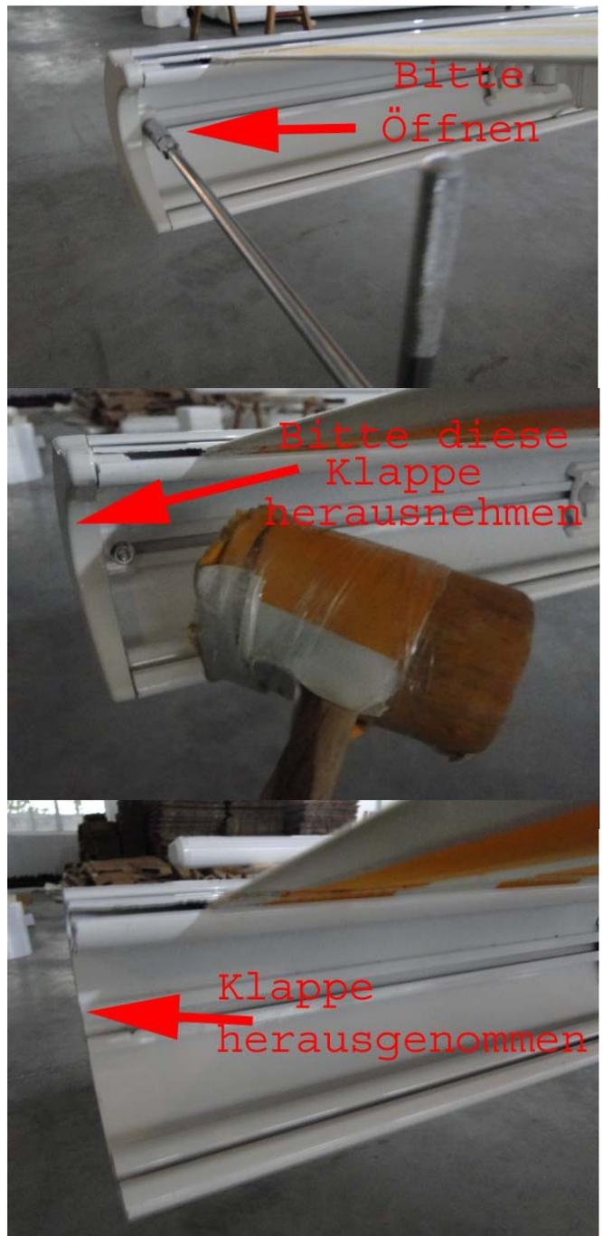
Jetzt können Sie den Markisenstoff zur Seite verschieben, so dass Sie auf der entgegengesetzten Seite Zugang zu dem LED Streifen erhalten:
