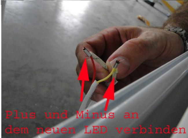
Kabelverbindungszubehör bekommen Sie sehr kostengünstig in jedem Baumarkt. An der Stelle an dem die beiden Pole miteinander verbunden werden, werden mit einer kurzen Plastikummantelung zusätzlich geschützt. Sie können selbstverständlich auch ein weißes Klebeband anwenden.
