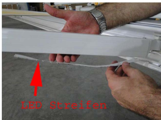
Der LED Streifen ist zusätzlich mit einem doppelseitigem Klebeband befestigt.
